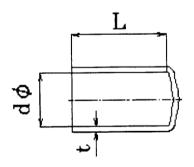
受注生産品。線材等の先端を保護する丸外かぶせキャップです。 L寸法(長さ調整できます)。色は、黒、白、グレー、赤、黄、他
