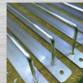
丸棒加工品 【SPCC+丸棒溶接】
