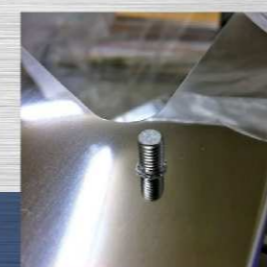
スタッド溶接 【鉄+SUS+アルミスタッド溶接】
