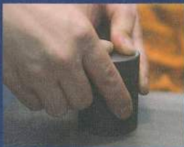
手加工のラッピング作業
