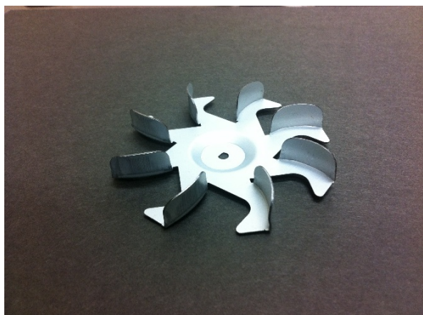
SECC t0.6 φ80 ファン部品 中央の絞りとフィン一体成形
