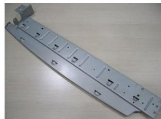
SECC t0.5 家電部品      SECC t1.2 OA機器部品
