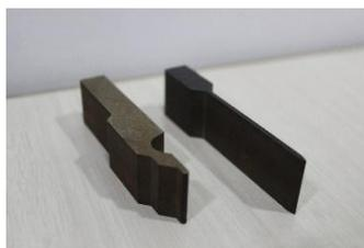
アルミ切削 組み付け治具      SKDワイヤ放電 曲げ型
