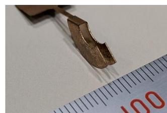
SUS t0.3 切断ナブ 直径2ミリ      C5210 t0.2 接点
