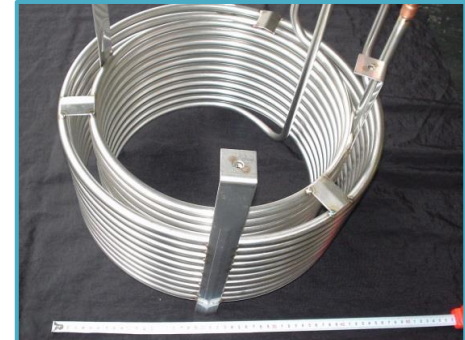
SUS304 6m×4本溶接 巻径φ410
